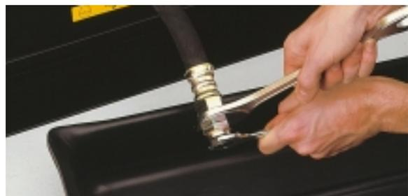
Motoröl und Kühlmittel können einfach über eine große Öffnung **12** am Grundrahmen abgelassen werden.
