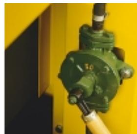
Das Motoröl kann über eine integrierte Ablasspumpe abgelassen werden. Diese gehört bei den QAS 150-300 - Modellen zur Standardausrüstung.
