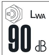
QAS-Generatoren sind superleise. Durch die ausgeschäumte Schallschutzhaube wird der Schallpegel so weit reduziert, dass die neuesten europäischen Vorschriften (2000/14 EG) in vollem Umfang erfüllt werden. QAS-Generatoren können in der Nacht in lärmempfindlichen Bereichen, wie geschlossenen Wohngebieten oder in der Nähe von Krankenhäusern, betrieben werden.
