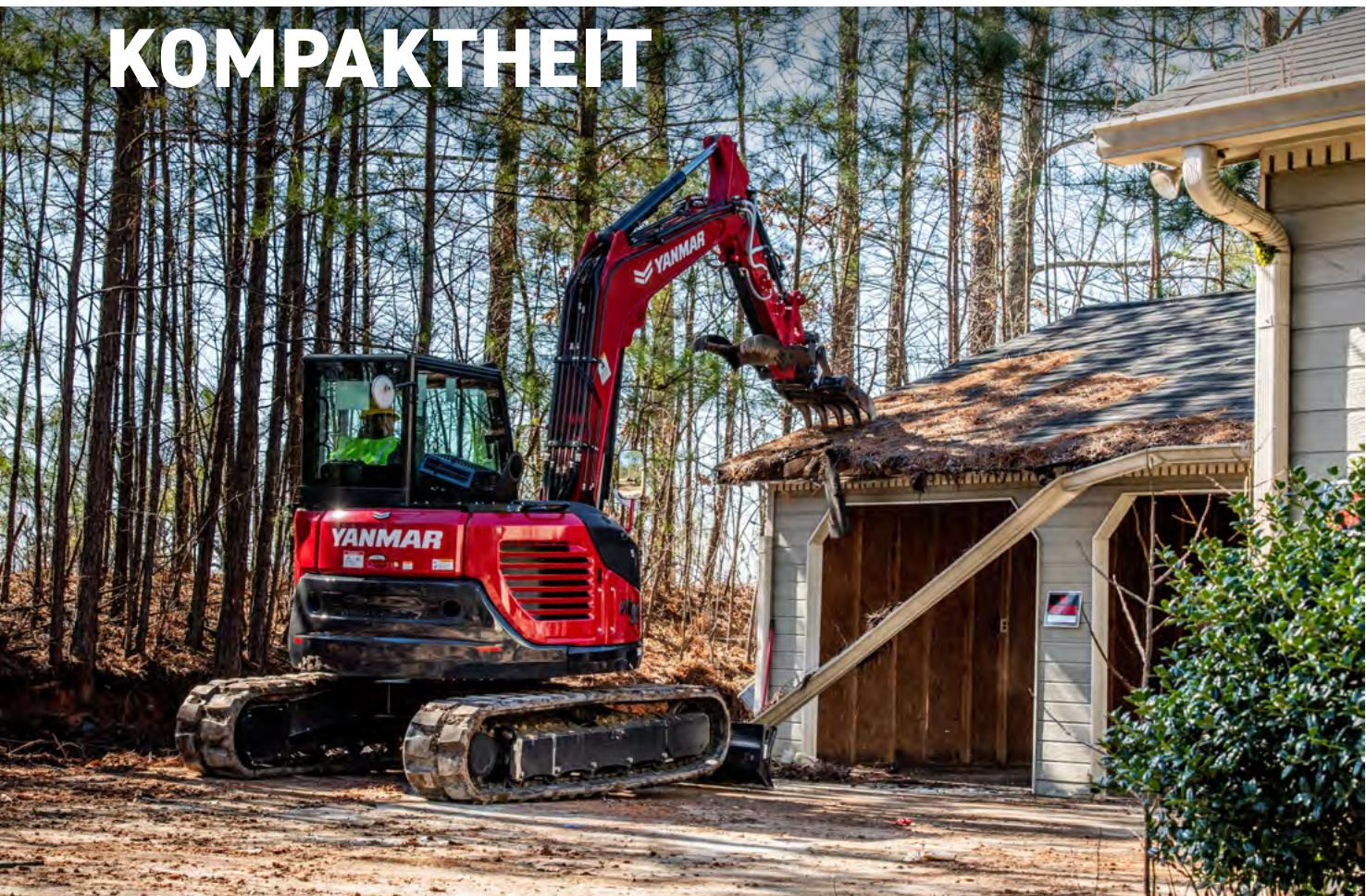
Der Vi080-1 kombiniert die Leistung eines Großbaggers mit den Vorteilen eines Kompaktbaggers. Er eignet sich ideal für urbane Bereiche und er lässt sich sicher und effizient entlang Wänden und in engen Bereichen manövrieren, zu denen andere Maschinen seiner Gewichtsklasse keinen Zugang haben.
