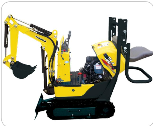
Totale Öffnung der Motorhaube für problemlosen Zugang zu allen Wartungspunkten
