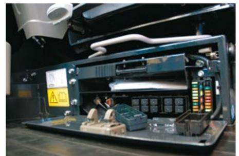
Die Ventilatorriemen sind über eine Klappe, rechts an der Kabine, zugänglich, die Batterie ist durch eine Metallplatte geschützt, rechts unter der hinteren Motorhaube eingebaut, die Elektrik befindet sich unter dem Sitz.
