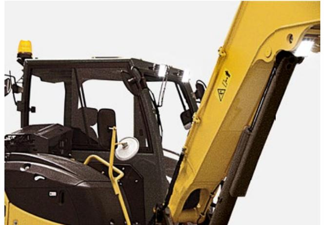
längeren Lebensdauer der Batterie. Eine Rundumleuchte und ein zusätzlicher LED-Scheinwerfer können als Option am Heck der Kabine montiert werden.
