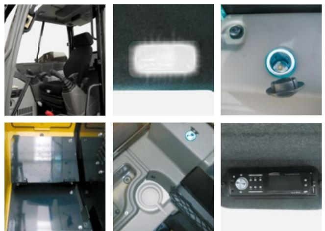
Die Serienausstattung umfasst u.a.: ein Radio mit USB-Anschluss, mehrere Handläufe, viele Staufächer, eine automatische Deckenleuchte, einen Flaschenhalter, 2 Steckdosen 12 V, einen Kleiderhaken, einen Werkzeugkasten, etc.
