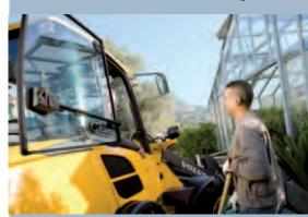
Vollständig zu öffnendes Seitenfenster sorgt für gute Belüftung.
