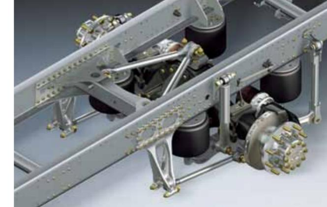
TGM 4-Balg-Luftfederung an der Hinterachse. Optionale schwere Hinterachse, 11,5 Tonnen Traglast.
