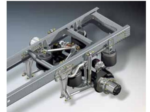
Luftfederung an der Hinterachse.
