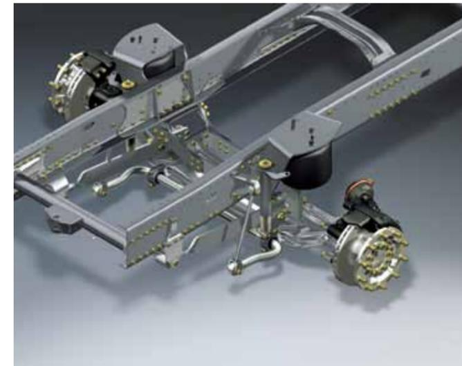
TGM Luftfederung an der Vorderachse.
